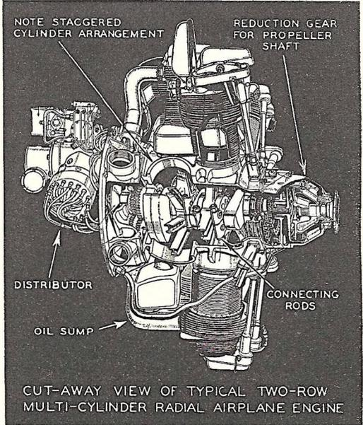
NOTE STAGGERED CYLINDER ARRANGEMENT
